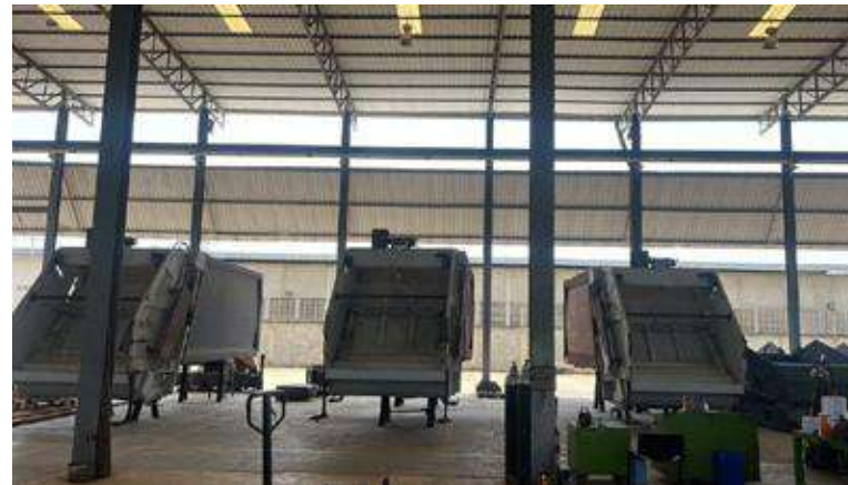
Ensamble y armado de cajas compactadoras
