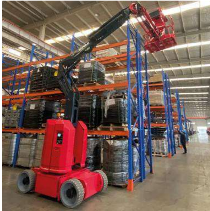
Elevador articulado Altura de trabajo desde 11M hasta 23M / Capacidad de carga hasta 250 kg
