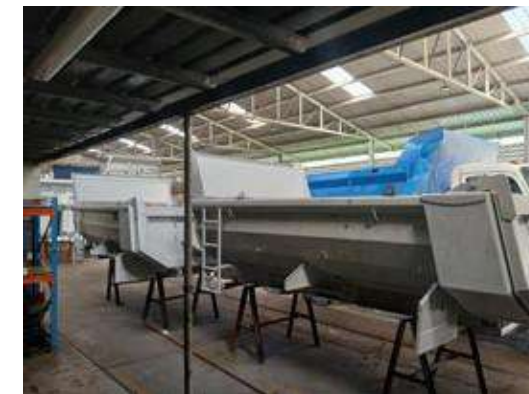
• Proceso de ensamble volco de 14m 3
