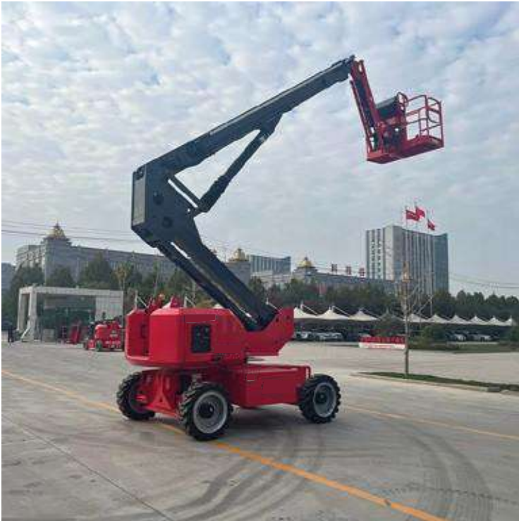
Elevador telescópico Altura de trabajo desde 18M hasta 28M / Capacidad de carga 300/450 kg
