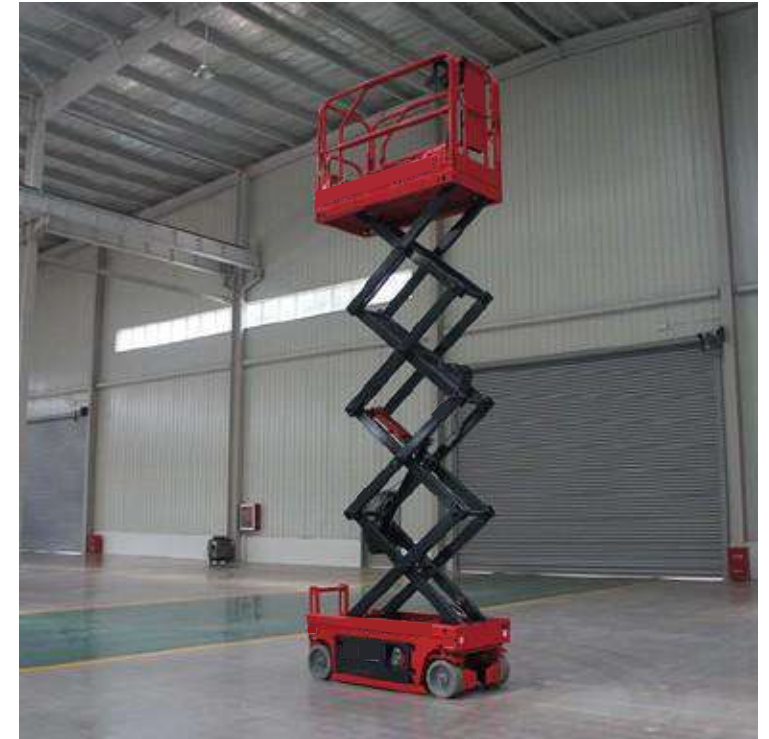
Elevador articulado Altura de trabajo desde 6M hasta 16M / Capacidad de carga hasta 450 kg
